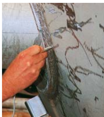
图2： 测量焊缝处的 铁素体含量
