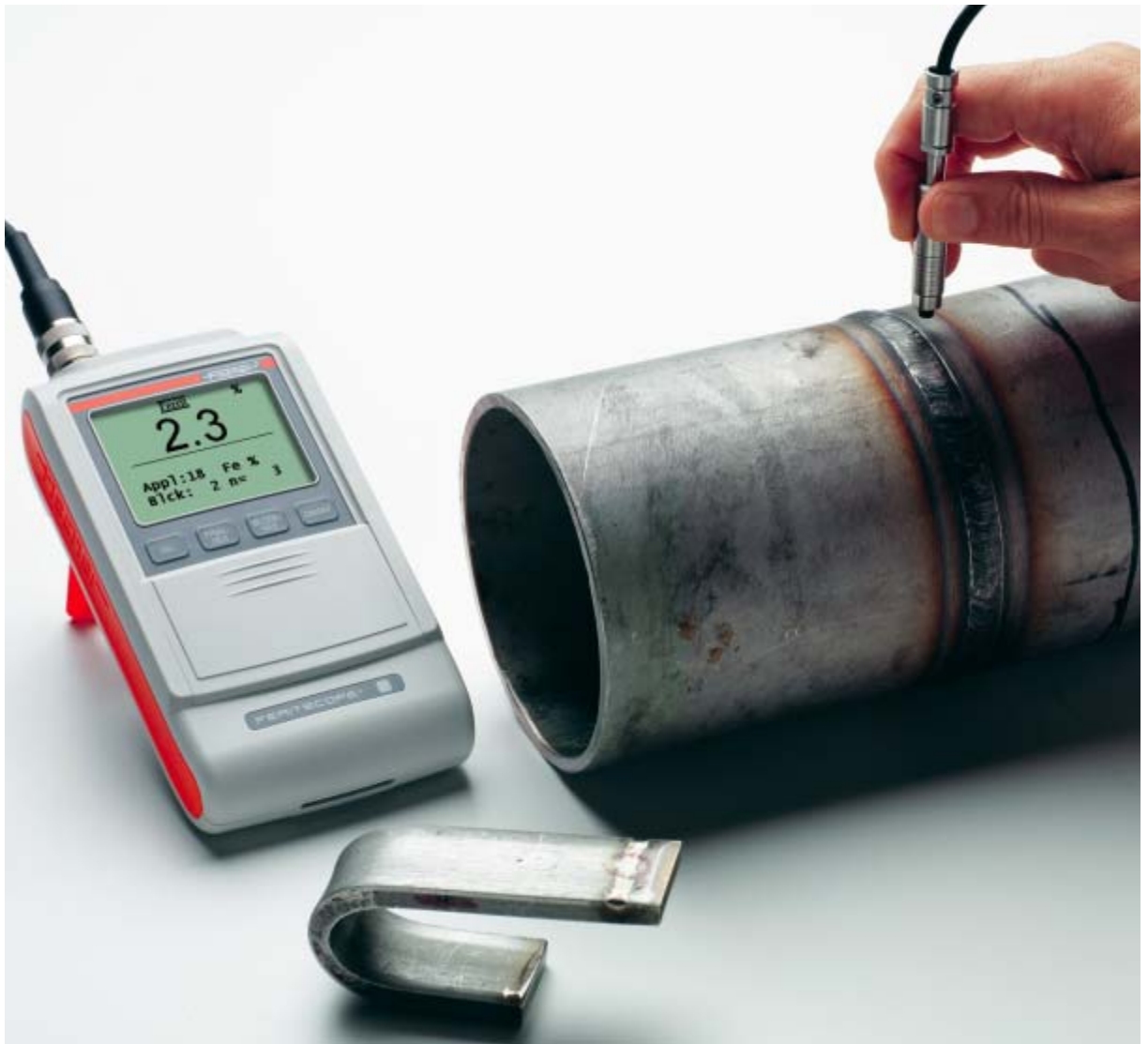
用FERITSCOPE FMP30测量焊缝内的铁素体含量
